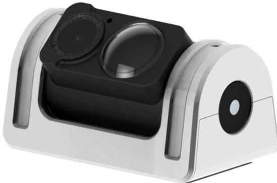
A câmera mini C24 é feita de metal e projetada para resistir à vibração e ao calor, específica para aplicação em sistemas de vigilância veicular. Atende aos rigorosos requisitos de amortecimento do veículo e pode ser ajustada verticalmente de 0 a 90 graus.
